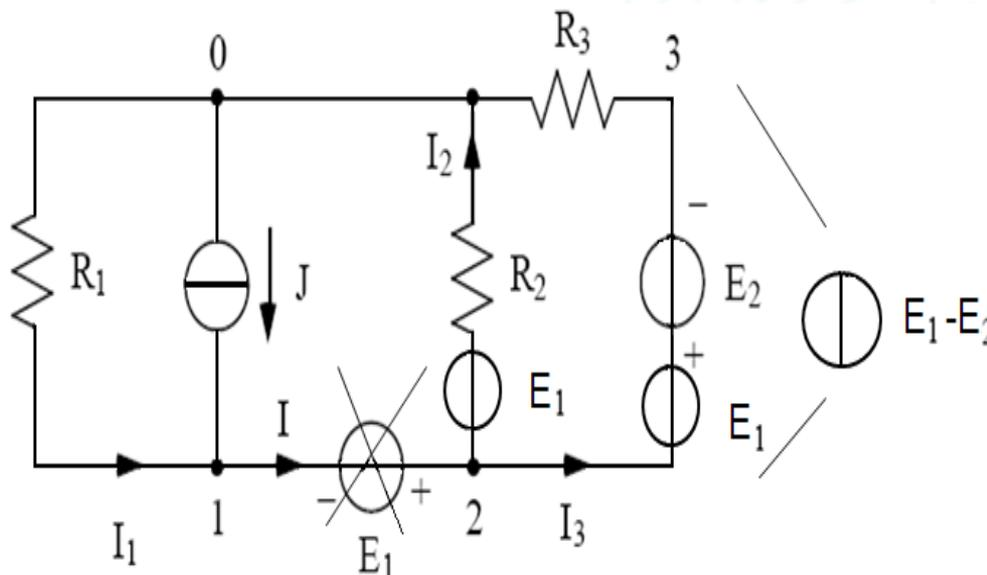
Sostituiamo alla serie dei due generatori di tensione un unico generatore dato dalla somma algebrica tra  $E_1$  e  $E_2$
