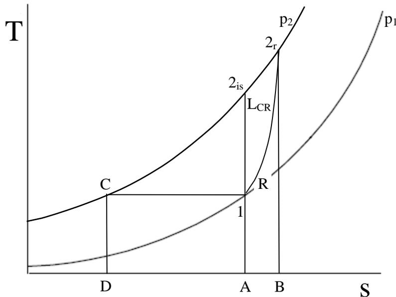
Fig. 8.1 – Trasformazione di compressione
