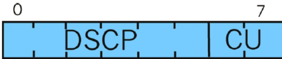
**Figura 8.29 – Struttura del campo DS nell'intestazione IPv4 e IPv6**
